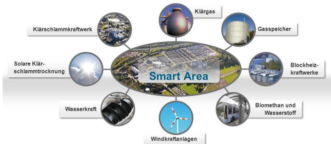
Bild 4: Energiedrehscheibe Kläranlage (in Anlehnung an [2]); EGLV
